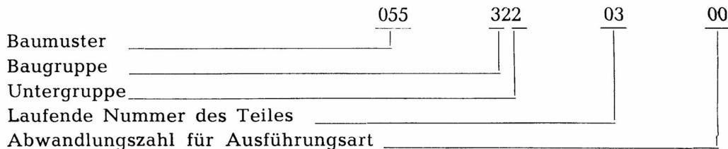
Teile-Nr., welche an Stelle der Untergruppenzahl mit einer 0 gekennzeichnet sind, weisen darauf hin, daß die Teile-Nr. einen aus mehreren Einzelteilen bestehenden Zusammenbau bezeichnet. (z. B. 055 060 01 00 Hinterachskopf, vollst.)
