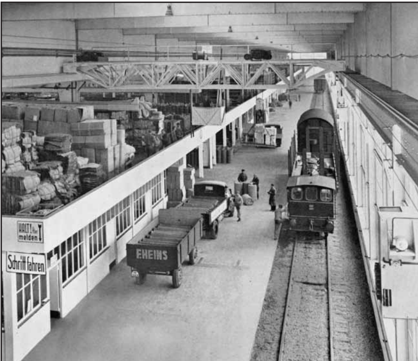
Die Werkseisenbahn mit Anschluss zum Reichsbahnnetz fuhr direkt in die Fertigungshallen hinein und konnten dort entladen werden, ohne dass man dem Wetter ausgesetzt war.
